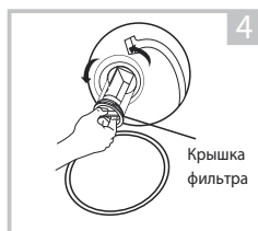
Откройте крышку фильтра, повернув против часовой стрелки
