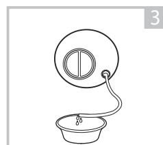
Когда вода стечет, уберите шланг аварийного слива
