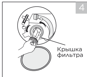
Откройте крышку фильтра, повернув против часовой стрелки
