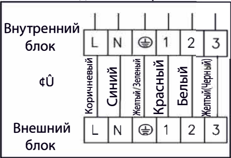
④ Диаграмма соединения для моделей 24, 30 (модели с обогревом)
