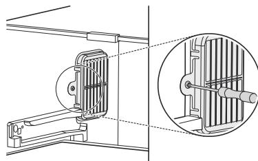
**3** Нажмите на фиксирующие зажимы дезодоратора и извлеките его.
