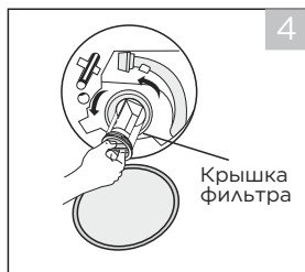
Откройте крышку фильтра, повернув против часовой стрелки
