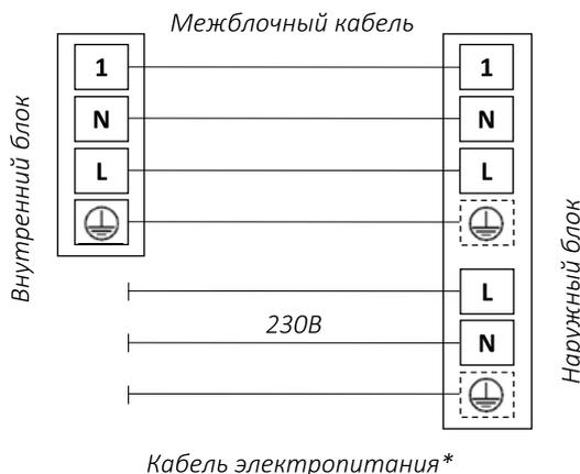
\*Кабель электропитания подключен к плате управления наружного блока блока
