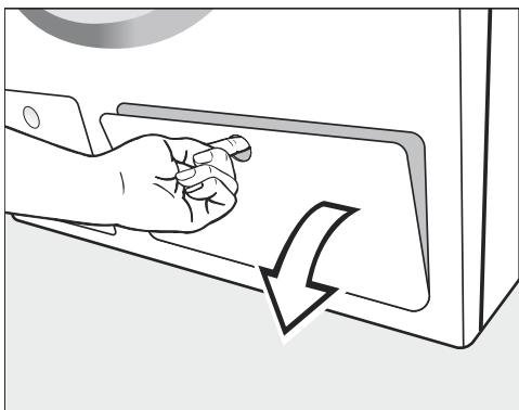
■ Для открывания потяните крышку отсека TwinDos.
