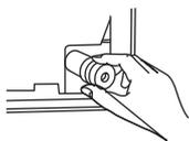
Для предотвращения нежелательных утечек закройте неиспользуемое дренажное отверстие прилагаемой резиновой пробкой.
