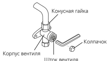
12. С помощью шестигранного ключа полностью откройте клапаны высокого и низкого давления.
