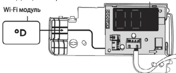
6. Установите дисплейный модуль на место, закрутите винт крепления дисплея.
