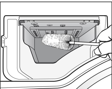
■ С помощью ёршика для мытья бутылок регулярно удаляйте остатки моющих средств и отложения извести с форсунок подачи воды в отсеке.
