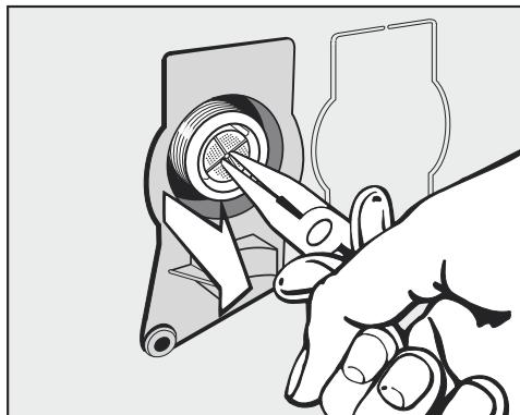
■ Выньте сетку фильтра острогубцами, взявшись за перегородку.
