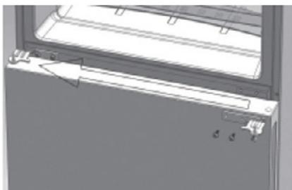
б) Прикрепите дверцу холодильника и установите верхнюю петлю на противоположной стороне прибора.
