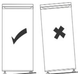
В процессе установки необходимо выровнять изделие относительно горизонтального уровня. В противном случае могут возникнуть проблемы из-за неплотного закрывания двери: повышенное образование наледи, повышенное потребление электроэнергии, некорректный температурный режим и т.п. Для выравнивания используйте регулируемые ножки. Вращая их против часовой стрелки, Вы можете приподнять передний край изделия. При вращении по часовой стрелке - опустить.
