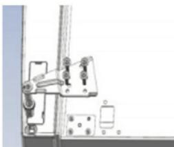
в) Вставьте дверную петлю и кабельное соединение в отверстие в двери, а затем прикрепите маленькую торцевую заглушку.
