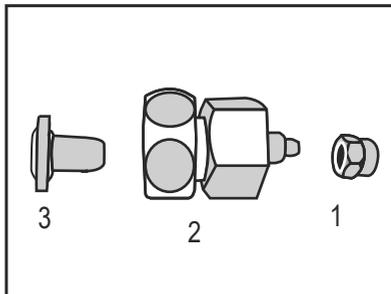
2. Подсоедините переходник крана к клапану магистрали водопровода.
