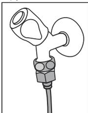
5. Во избежание поломки, сдвига или случайного отсоединения шланга используйте хомуты, чтобы надежно зафиксировать водный шланг.
