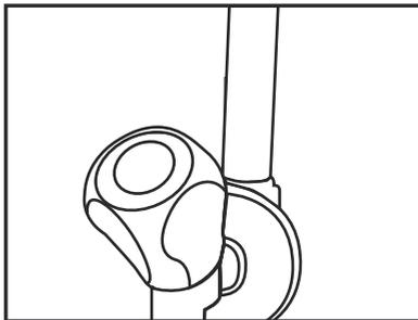
4. Подсоедините водный шланг, выходящий из верхней части фильтра, к переходнику для подключения воды к изделию (см.
