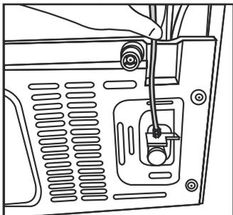
3. Затяните соединитель вручную, чтобы зафиксировать переходник шланга. Можно воспользоваться разводным ключом или плоскогубцами.
