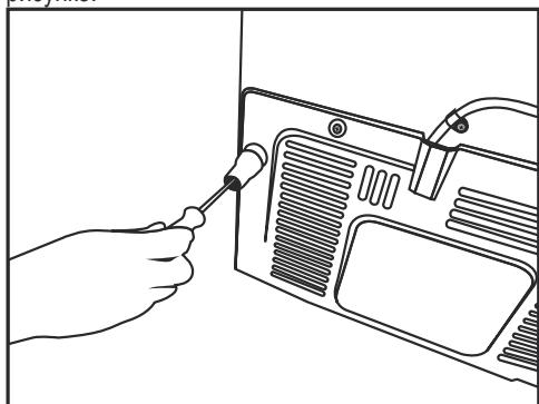
Для вертикальной регулировки дверей ,
