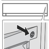
Используется, когда пульт дистанционного управления не соответствует или работает неисправно. Поднимите переднюю панель:
