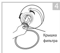
Откройте крышку фильтра, повернув против часовой стрелки
