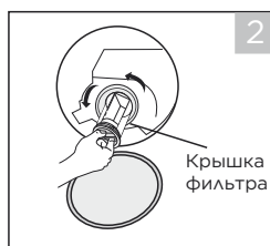
Откройте крышку фильтра, повернув против часовой стрелки
