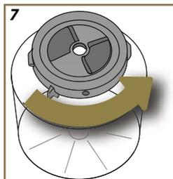
11. Возьмите один из контейнеров для зерен, переверните его и убедитесь, что нижняя часть хорошо закрыта: для уверенности поверните нижнюю часть против часовой стрелки до щелчка (рис. 7). Контейнер для зерен закрыт правильно, если две стрелки совмещены (рис. 8). Нажмите «Далее».
