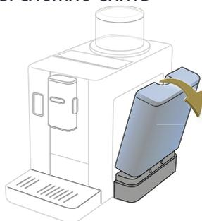
*Наклоните бачок наружу: после отцепления его можно легко снять.*
