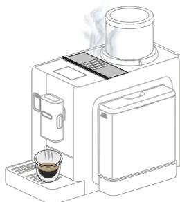
*Это пар, выделяющийся из использованной порции кофе и автоматически удаляемый в контейнер для кофейной гущи машины. Это нормальная и правильная работа машины.*
