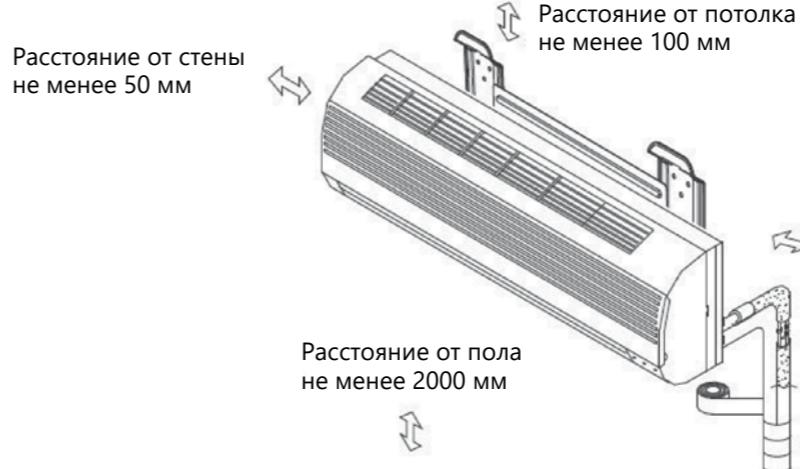
⚠ Поверхность стены, на которой устанавливается внутренний блок, должна быть гладкой и ровной, конструкция стены должна выдерживать нагрузку не менее 60 кг.
