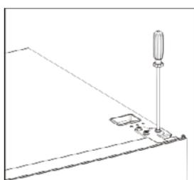
3. Выньте штифт с помощью отвертки и переверните кронштейн петли. Затем установите штифт на кронштейн петли.
