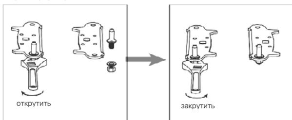
11. Установите на место кронштейн, подходящий к штифту нижней петли. Установите на место обе регулировочные ножки.
