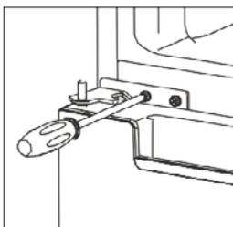
15. Замените верхнюю дверь, убедитесь, что дверь выровнена со шкафом, чтобы уплотнитель двери плотно прилегал к шкафу. Затем соедините дверь со шкафом, плотно зафиксировав верхнюю петлю.
