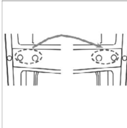
9. Отвинтите нижний шарнир. Затем снимите регулировочные ножки с обеих сторон.
