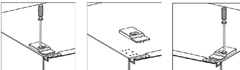
7. Снимите верхнюю дверцу, крестовой отверткой выньте винт из средней петли, затем снимите нижнюю дверцу.
