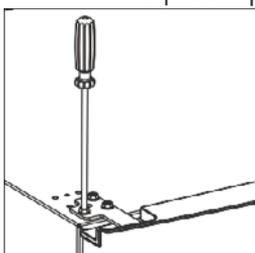
16. Подсоедините жгуты от двери и шкафа. Затем установите крышку верхней петли. Перед тем как закрутить крышку, подключите клеммы дверного выключателя.
