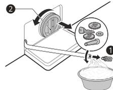
**4** После очистки фильтра сливного насоса выньте его и вставьте сливную пробку.
