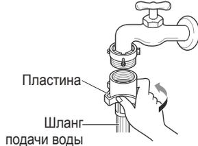
**Подключение зажимного шланга к крану без резьбы**
