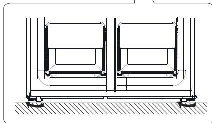
Выравнивание и закрепление холодильника путем регулировки ножек:
