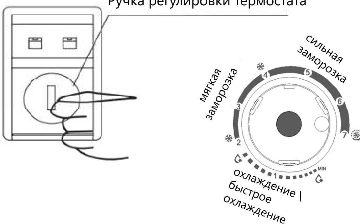
Температура морозильной камеры регулируется с помощью ручки, установленной на термостате. Цифры указанные на термостате «1, 2, 3, 4, 5, 6, 7» не обозначают конкретную температуру. Чем меньше цифра, тем выше температура:
