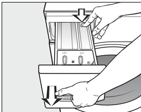
■ Выдвиньте отсек для моющих средств и добавок до упора, нажмите на кнопку открывания и извлеките отсек.
