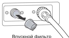
Очистите фильтр клапана впуска воды или переустановите шланги подачи воды.
