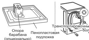
Снимите транспортировочные болты и опоры.
