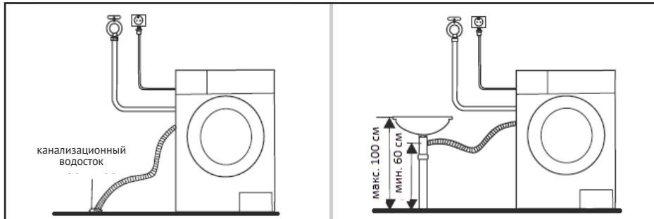
Гофрированный сливной шланг должен быть подключен к сливу на высоте 60-100 см от пола.
