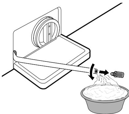
**4** Медленно отверните фильтр сливного насоса, чтобы слить остатки воды, а затем удалите все загрязнения и посторонние предметы из фильтра.
