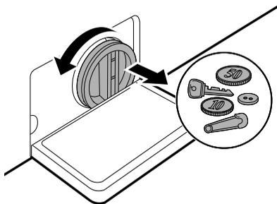
**5** После завершения очистки фильтра сливного насоса осторожно установите фильтр на место и снова заверните крышку сливного отверстия по часовой стрелке так, чтобы исключить заедание резьбы и утечку жидкости. Снова установите заглушку в
