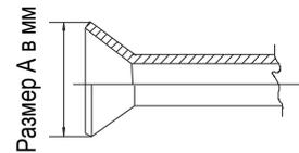
Развальцовку трубы следует выполнять специальным расширительным инструментом для R32. При развальцовке труб с R32 с использованием обычного расширительного инструмента необходимо, чтобы выступ медной трубки за шаблон был в диапазоне от 1.0 до 1.5мм. Также при использовании обычного расширительного инструмента выступающий отрезок трубы рекомендуется отмерять измерительным инструментом для медной трубы.
