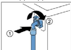
2. Подсоедините шланг подачи воды к водопроводному крану (26,4 мм = 3/4").
