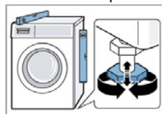
Все ножки прибора должны твердо стоять на земле.
