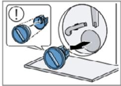
2. Очистите внутреннюю часть, резьбу крышки и корпус насоса.
