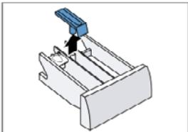
4. Очистите отсек для моющих средств и вставьте его водой и щеткой, затем высушите.
