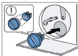
5. Закрутите крышку насоса до упора.
