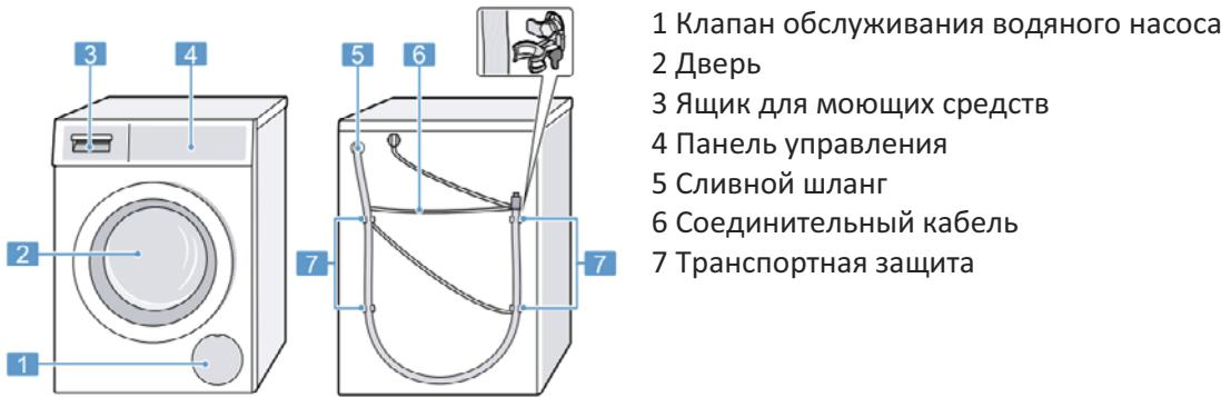
В зависимости от типа устройства детали, показанные на иллюстрации, такие как цвет и форма, могут различаться.
