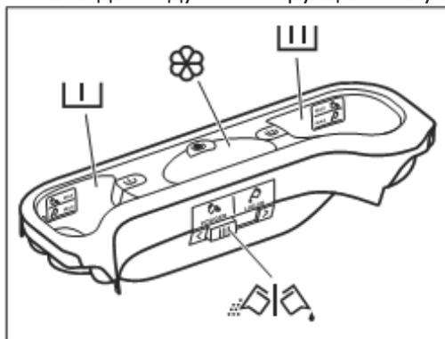
**I** Отсек для моющих средств для этапа предварительной стирки. Маркировка MAX — это максимальное количество моющего средства (порошкового или жидкого).
