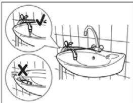
**i** Убедитесь, что пластиковая направляющая не может двигаться во время слива воды из прибора, а конец сливного шланга не погружен в воду. Возможен возврат грязной воды в прибор.
