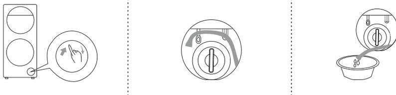
Выньте и промойте фильтр. Установите фильтр обратно, тщательно закрутив его по часовой стрелке, и закройте крышку.
