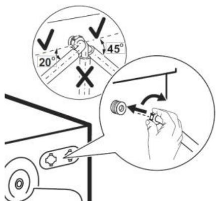
1. Подключите наливной шланг к задней стороне прибора.
