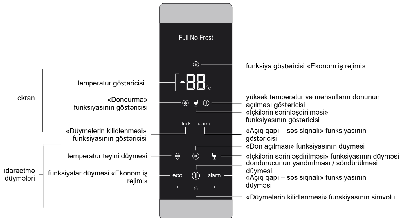
Şəkil 3 – İdarəetmə paneli
