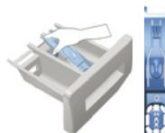
**🔧 ПРИМЕЧАНИЕ:** Поднимите заднюю часть рассекателя, чтобы снять его, как показано на рисунке. После выполнения вышеуказанных процедур очистки, установите рассекатель на место и опустите его переднюю часть и убедитесь, что фиксирующий язычок попал в паз.
