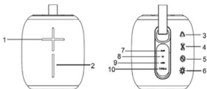
1. + Кнопка перехода к следующему файлу (продолжительное нажатие) / увеличения громкости (краткое нажатие) / переключения на следующую радиостанцию в режиме радиоприемника (продолжительное нажатие).
