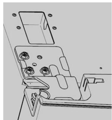
10. Снимите верхнюю левую крышку шарнира, подсоедините жгут проводов и установите его на шкаф.
