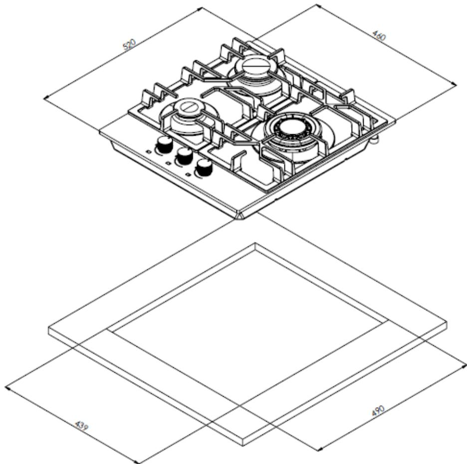
Данный прибор должен быть встроен в шкаф кухонного гарнитура или столешницу толщиной 300 мм, при этом должны быть соблюдены требования в отношении минимальных расстояний:
