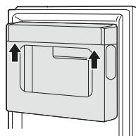
**3** Выполните установку лотка системы Дверь-в-двери в порядке, обратном порядку извлечения.
