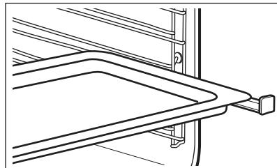
**Одновременная установка решетки и эмалированного противня:**
