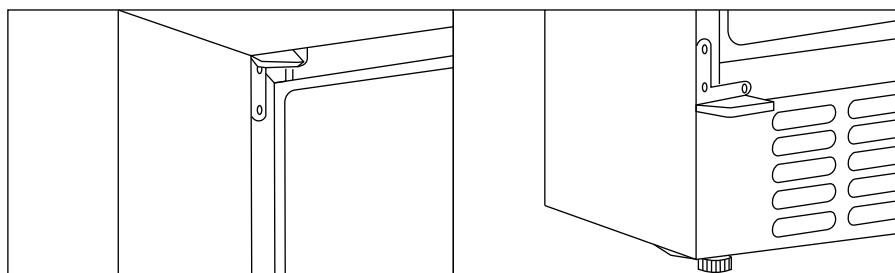
**10.** Зафиксируйте положение дверцы и закрепите петли винтами.
