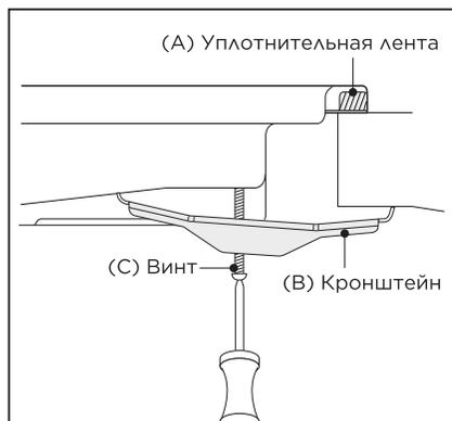
1. Поместите кронштейн (В) над отверстиями, которые соответствуют размерам винтов. В каждом углу варочной панели имеется один комплект отверстий под винты.
