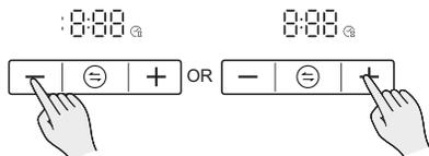
После розжига конфорки вы можете установить таймер. Нажмите и удерживайте "—" или "+" для входа в настройки таймера. При помощи этих же кнопок установите время - каждое нажатие добавляет или уменьшает на 1 минуту, удерживание кнопки ведет к быстрой прокрутке времени. Диапазон настройки составляет 1-180 минут.
