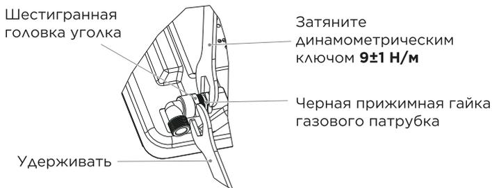
После ослабления уголка поверните его во внутреннем направлении и удерживайте шестигранную головку уголка неподвижно с помощью гаечного ключа.
