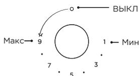
Включите варочную панель в сеть, затем разжигайте огонь. Нажмите на ручку регулятора конфорки, которую нужно зажечь, и поверните ее против часовой стрелки в положение максимального пламени, сработает автоматический розжиг конфорки.
