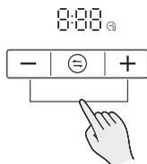
Чтобы отменить таймер, нажмите и удерживайте "—" и "+" одновременно. Конфорка продолжит работать в обычном режиме.
