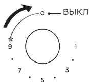
Чтобы выключить конфорку, поверните ручку регулятора по часовой стрелке до упора в положение «Выключено».
