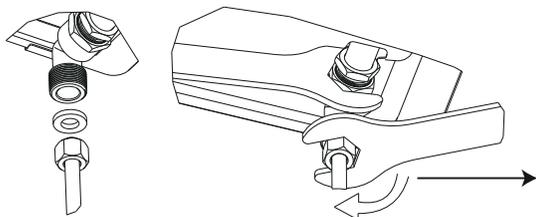
Не прикладывайте излишнюю силу при затягивании; в противном случае это приведет к поломке уголка или деформации уплотнительной прокладки и утечке газа. Обратите внимание, что для затягивания необходимо использовать динамометрический ключ с крутящим моментом 10 Н/м (макс. 20 Н/м).
