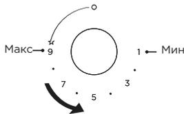
После розжига конфорки, для регулировки ее мощности поворачивайте ручку регулятора против часовой стрелки, пока пламя не достигнет подходящего уровня. Регулируйте интенсивность пламени между максимальным и минимальным положением.
