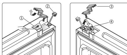
8. Открутите винт 3 и снимите детали 2 и 1. Установите прилагаемые левый ограничитель открывания двери 4 и левый упор ограничителя 5 (в пакете) с левой стороны и закрепите с помощью винта 3. Сохраните детали 1 и 2 для дальнейшего использования.
