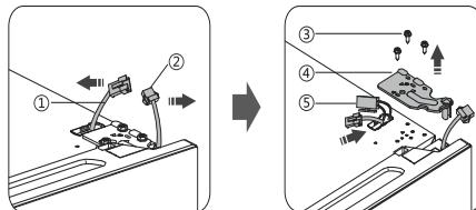
5. Приподнимите и аккуратно снимите верхнюю дверцу со среднего шарнира. Положите дверцу на мягкую поверхность, повернув лицевой панелью вверх.
