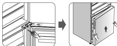
10. Положите дверь на мягкую поверхность лицевой панелью вверх. Открутите винт 3 и снимите детали 2 и 1. Установите прилагаемые левый ограничитель открывания двери 4 и левый упор ограничителя 5 (в пакете) с левой стороны и закрепите с помощью винта 3.
