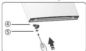
9. С помощью шестигранного ключа (в пакете) и крестовой отвертки ослабьте винты и снимите средний правый шарнир. Снимите нижнюю дверь.
