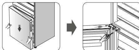
16. Установите верхнюю дверцу. Выровняйте дверцу и проверьте, чтобы стержень среднего шарнира попал в отверстие с нижней стороны двери. Прикрутите шарнир 2 (в пакете) винтами 1. Во время этих действий придерживайте верхнюю дверь рукой.
