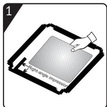
1. Перед установкой шумоподавляющего коврика нужно выровнять и прикрепить шумоподавляющую вату вдоль прямоугольного выреза на шумоподавляющем
