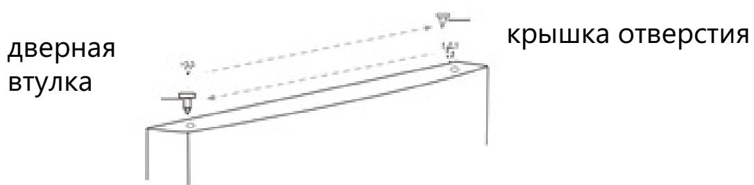
10. Удалите винт, который крепит крышку отверстия для винта петли в верхней левой части корпуса, снимите крышку и закрепите крышку в верхней правой части корпуса.
