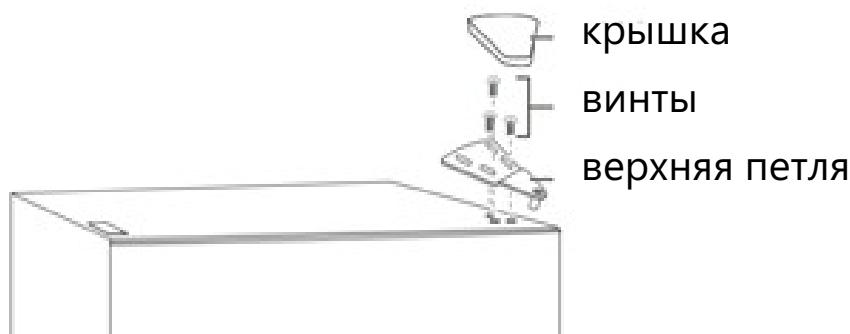
2. Снимите дверь морозильной камеры.
