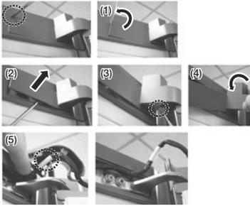
4. Снимите соединительный зажим на дверце холодильника. (Только на моделях с внешним дисплеем).
