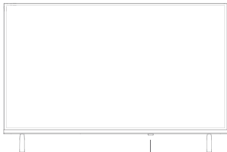
кнопка питания/инфракрасный датчик/ индикатор питания
