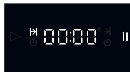
сначала выберите минуты с помощью кнопок –/+ , затем активируйте часы нажатием на кнопку OK
