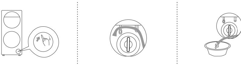
Выньте и промойте фильтр. Установите фильтр обратно, тщательно закрутив его по часовой стрелке, и закройте крышку.
