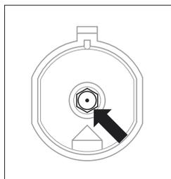
Înlocuirea duzei arzătorului - duza trebuie deșurubată cu ajutorul unei chei tubulare 7 și înlocuită cu una nouă corespunzătoare pentru tipul de gaz (vezi tabelul de mai sus).
