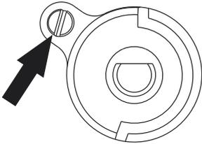
Zur Prüfung der Flamme sollte der Brenner bei Vollflamme über ca. 10 Minuten brennen und anschließend der Hahnregler auf Sparflamme umgestellt werden. Die Flamme sollte dabei weder erlöschen noch auf die Düse überspringen. Sollte dies allerdings der Fall sein, sollte die Regulierung der Gashähne wiederholt werden.
