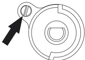
Pentru a verifica flacăra trebuie să încălziți arzătorul la flacăra completă timp de aprox. 10 min., și apoi să rotiți butonul supapei la flacăra economică. Flacăra nu trebuie să se stingă și nici să treacă pe duză. În cazul în care vreuna din aceste situații va avea loc trebuie să repetați reglajul.
