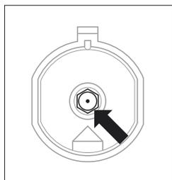
*Austausch der Brennerdüse – die Düse mit dem Sondersteckschlüssel 7 herausdrehen und gegen eine für die neue Gassorte geeignete Düse (siehe: vorstehende Tabelle) austauschen..*
