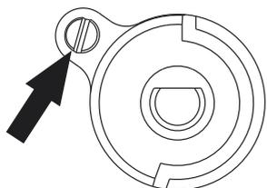
Чтобы проверить пламя, нужно прогреть конфорку на полном огне в течении 10 мин., а далее повернуть регулировочную ручку вентиля на экономное пламя. Огонь не должен гаснуть и перескакивать на форсунку. А если так произойдет, необходимо повторить регулировку вентилей.
