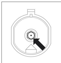
*Замена форсунки горелки - форсунку выкрутить с помощью специального насадочного ключа 7 и заменить на новую, соответственно виду газа (см. таблицу выше).*
