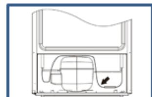
Запрещается переналадка или модификация каких-либо частей устройства. Крайне важно не повредить капиллярную трубку, видимую в углублении компрессора. Трубку нельзя сгибать, выпрямлять или наматывать.
