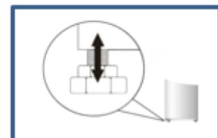
Задняя стенка холодильника, в частности конденсатор и другие элементы системы охлаждения, не должны соприкасаться с другими элементами, которые могут их повредить (например, трубы центрального отопления и водопровода).
