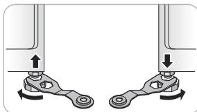
Поднимайте или опускайте устройство с помощью регулируемых ножек до тех пор, пока оно не перестанет раскачиваться из стороны в сторону и вперед-назад.
